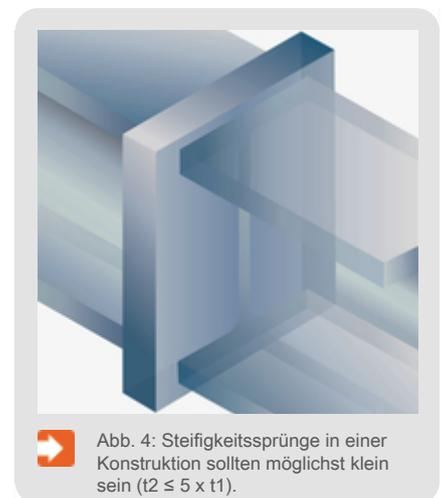
Abb. 4: Steifigkeitssprünge in einer Konstruktion sollten möglichst klein sein ( $t_2 \leq 5 \times t_1$ ).
