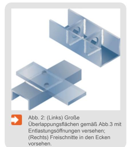
Abb. 2: (Links) Große Überlappungsflächen gemäß Abb.3 mit Entlastungsöffnungen versehen; (Rechts) Freischnitte in den Ecken vorsehen.
