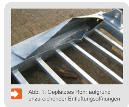
Abb. 1: Geplatzttes Rohr aufgrund unzureichender Entlüftungsöffnungen
