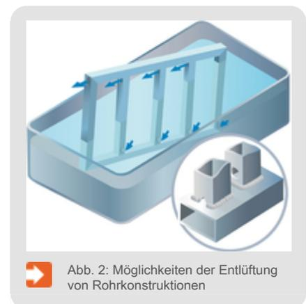
Abb. 2: Möglichkeiten der Entlüftung von Rohrkonstruktionen
