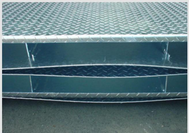
Abb. 2: Verzug an einem Bauteil durch Eigenspannungen
