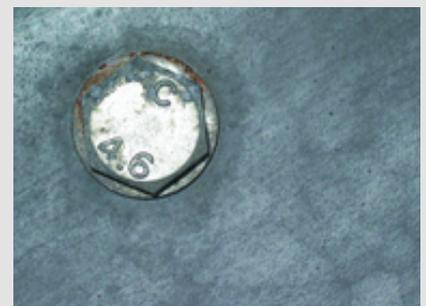
➔ Abb.3: Falsch - Galvanisch verzinkte Schraube mit beginnendem Rostrost in feuerverzinkter Stahlkonstruktion.
