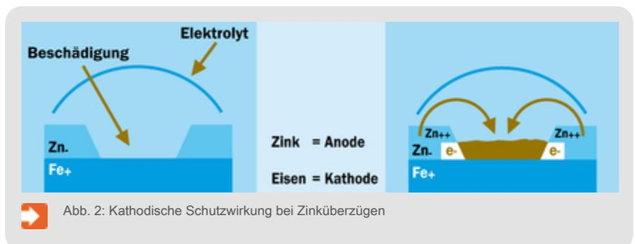
Abb. 2: Kathodische Schutzwirkung bei Zinküberzügen
