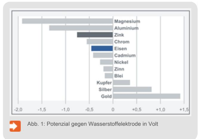
Abb. 1: Potenzial gegen Wasserstoffelektrode in Volt
