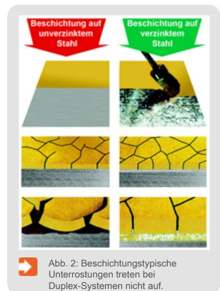
Abb. 2: Beschichtungstypische Unterrostungen treten bei Duplex-Systemen nicht auf.
