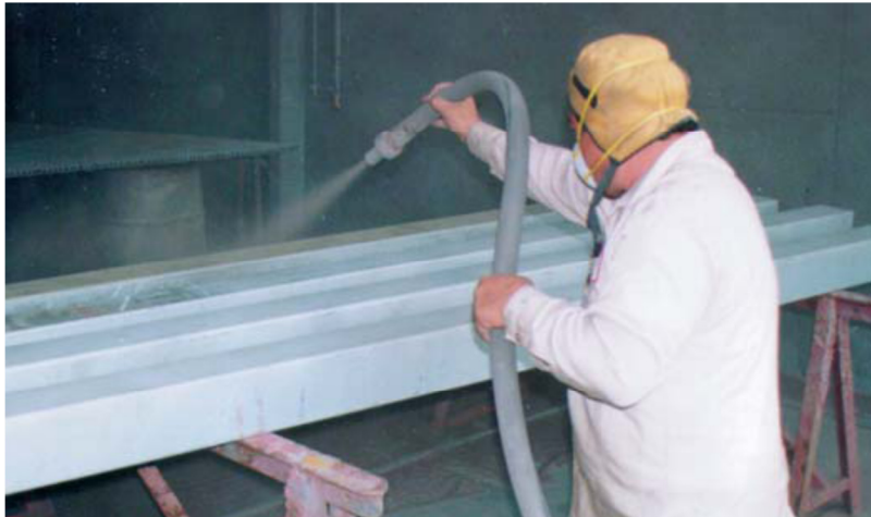
Lahko peskanje cinkove prevleke– sweepen, hkratno čiščenje in aktiviranje
